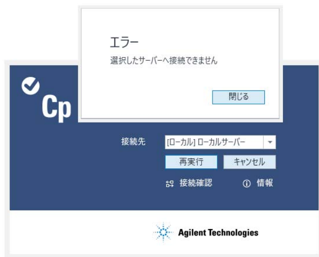
図 19 OpenLab CDS Shared Services サーバーへの接続なしに OpenLab Control Panel を起動
